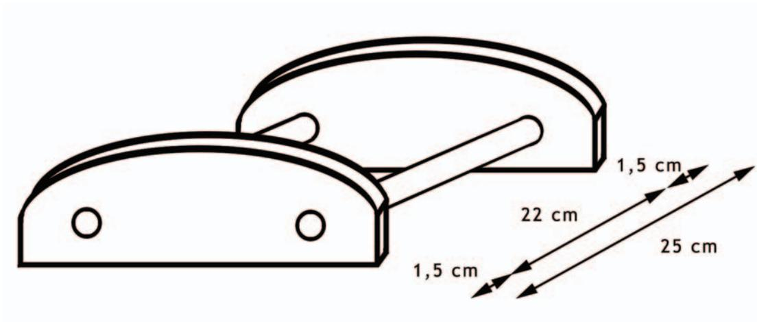
In die zugeschnittenen Seitenteile Löcher für die Querstangen bohren (Position ungefähr wie unten angegeben) und anpassen. Alles gut verleimen. Es empfiehlt sich, die Kanten der Seitenteile oben und an der Seite mit Schleifpapier abzurunden. Zum Schluss mit Antikwachs o.ä. einreiben.
